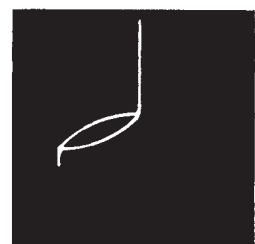
Transistor Emitter/Basis parallel mit 1µF + 680Ω
